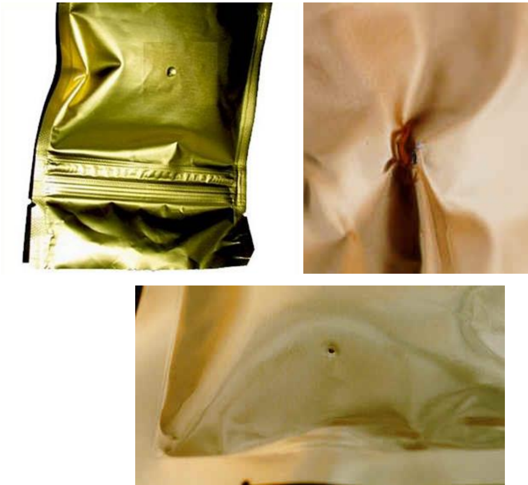
ภาพที่ 1 ลักษณะรูเข็มบนถุงรีทอร์ท
