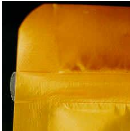
ภาพที่ 1 ลักษณะการปิดผนึกที่สมบูรณ์ของถุงรีทอร์ท
