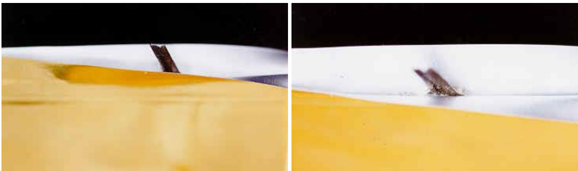
ภาพที่ 1 ลักษณะการปนเปื้อนบริเวณรอยปิดผนึกบนถุงรีทอร์ท
