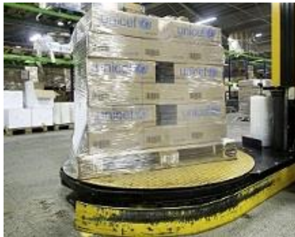
ภาพที่ 1 การใช้ฟิล์มพอลิเอทิลีนห่อสินค้าที่มีการวางเรียงบนพาเลทด้วยเครื่อง Turntable wrapper
