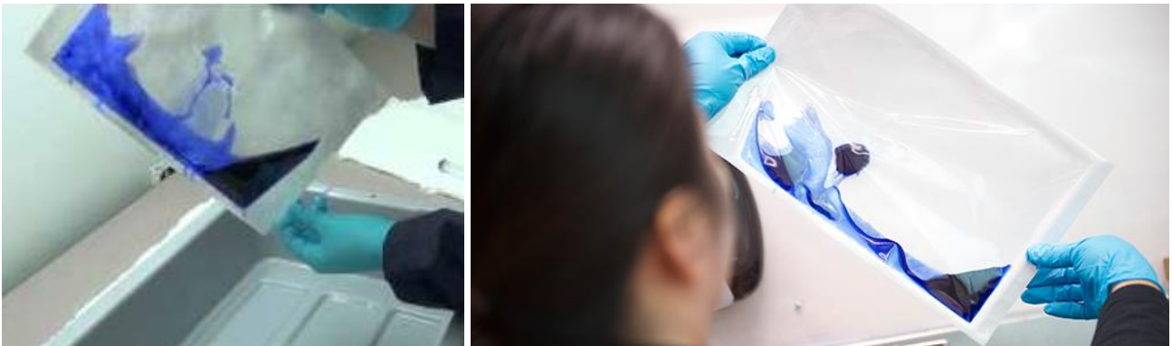
ภาพที่ 3 ลักษณะการทดสอบรอยรั่วของการปิดผนึกบรรจุภัณฑ์โดยใช้สีย้อม
