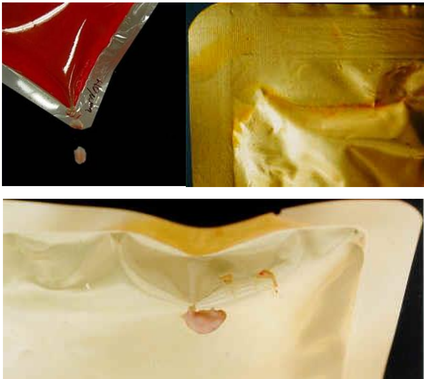
ภาพที่ 1 ลักษณะการรั่วของถุงรีทอร์ท
