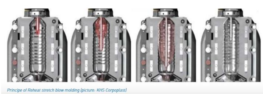
รูปที่ 2 หลักการของ Reheat Stretch Blow Molding
