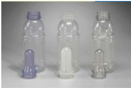
รูปที่ 1 ตัวอย่าง preform และขวดจากพลาสติก PET, PP, และ PLA (จากซ้ายไปขวา)
