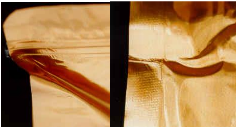
ภาพที่ 1 ลักษณะรอยพับบริเวณปิดผนึกของถุงรีทอร์ท
