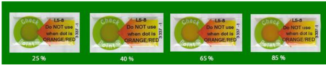
ภาพที่ 1 : ตัวอย่างป้ายฉลาก Checkpoint® ของตัวอย่างผลิตภัณฑ์อาหารทะเลสด เมื่อสัมผัสกับสภาวะอุณหภูมิที่ต่างกัน
