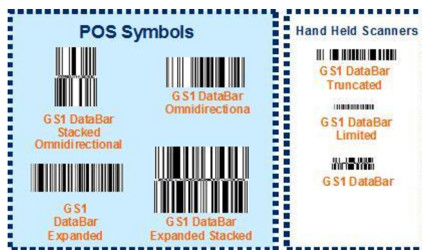
รูปที่ 3 ตัวอย่าง GS1-Barcode ในรูปแบบต่าง ๆ
