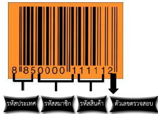
รูปที่ 2 ความหมายของเลขแต่ละหลักบนบาร์โค้ด
