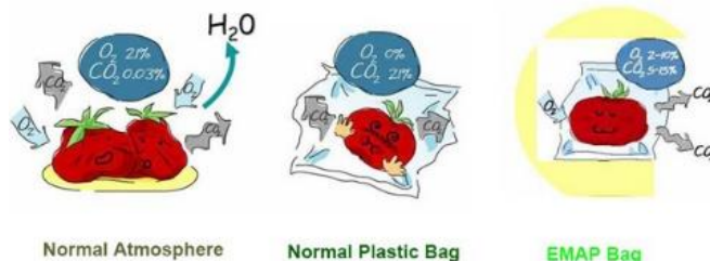
ภาพที่ 1 บรรจุภัณฑ์แบบดัดแปลงสภาพบรรยากาศ ณ จุดสมดุล ที่มา: packaging-gateway.com
